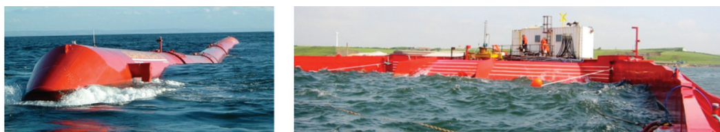
11. irudia. Ospetsuenetako olatu-bihurgailu bi: (a) Pelamis, (b) Wave Dragon.
