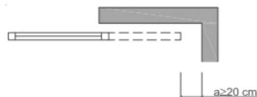
Ilustración 25: Holgura mínima para evitar atrapamientos en puertas
