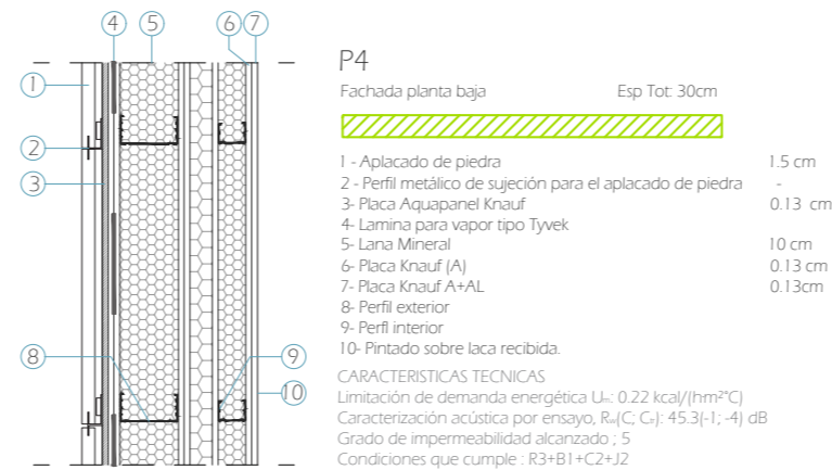
Figura 69: Sección fachadas exteriores
