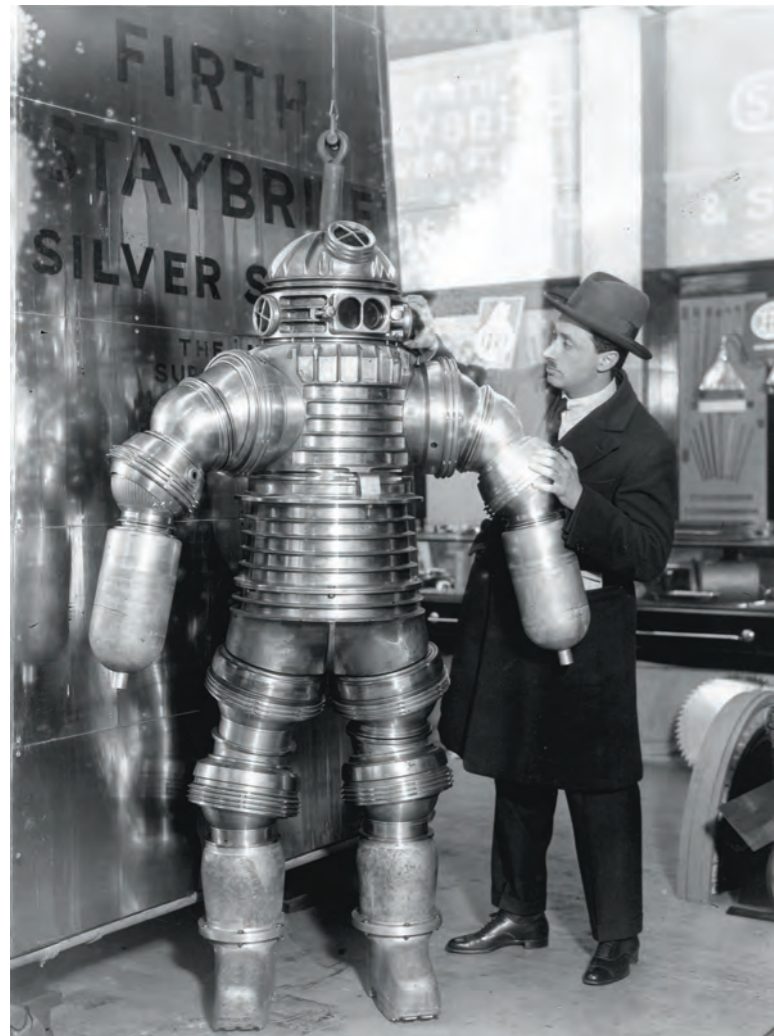
El 30 de noviembre de 1925, J.S.Peress explicaba durante la Olimpia Shipping Exhibition celebrada en Londres, el funcionamiento de una escafandra de buceo diseñada por él en acero inoxidable, que con un peso de 250 Kilos podía alcanzar profundidades de hasta 200 metros.
