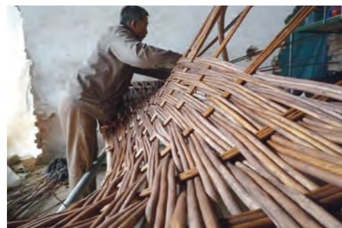
La textura cambiante de la fachada tiene su origen en las diversas fibras naturales utilizadas como materias primas, que van cambiando el color de los paneles, así como a los diversos trenzados. Todos ellos realizados en talleres de cestería tradicional china de forma manual.
