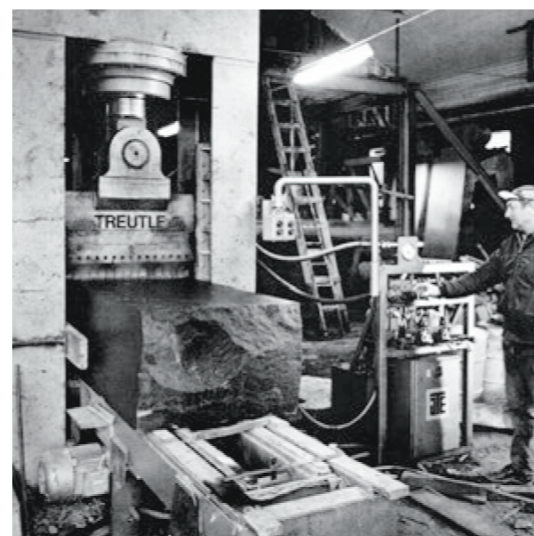
Máquina de corte desarrollada por Treutle para la realización de las piezas de piedra de la fachada del Banco Central de Suecia.
