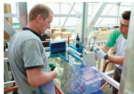
El desarrollo constructivo de los ladrillos obligó a una doble investigación centrada primero sobre el fundido de las piezas, y después sobre el tipo de adhesivo a emplear, que además de la estabilidad garantizase su posterior transparencia.
