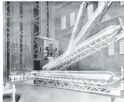
Sistema de Lubber para la fabricación industrial de vidrio.
