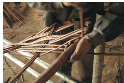
La textura cambiante de la fachada tiene su origen en las diversas fibras naturales utilizadas como materias primas, que van cambiando el color de los paneles, así como a los diversos trenzados. Todos ellos realizados en talleres de cestería tradicional china de forma manual.
