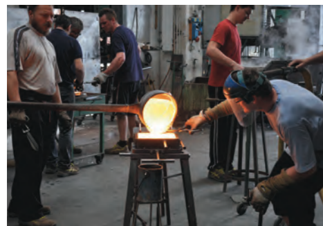
El desarrollo constructivo de los ladrillos obligó a una doble investigación centrada primero sobre el fundido de las piezas, y después sobre el tipo de adhesivo a emplear, que además de la estabilidad garantizase su posterior transparencia.
