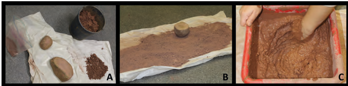
Fig.4.3. Preparación de la arcilla natural: A: Elementos utilizados; B: Tierra machacada; C: Mezclado con agua.
