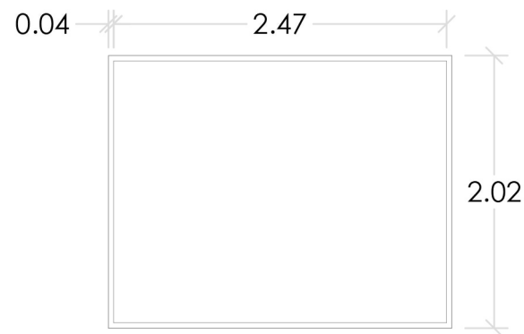
V3 lehioa 2 elementu PVC beira bikoitza aislaglas "CONTROL GLASS ACUSTICO Y SOLAR" Behe solairuko korridorearen amaieran eta kafetegian aurkituko dira
