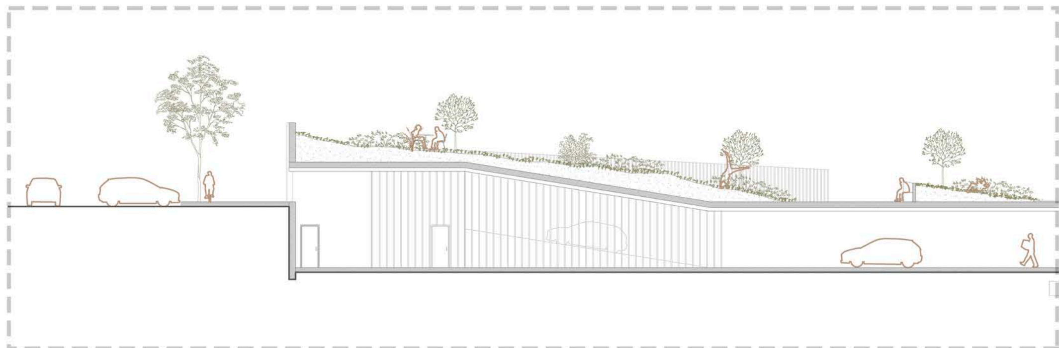
Parkinaren bigarren ebaketa , malda adierazten da. Aireztapen mekanikoaz gain, aireztapen naturala ezartzen da parkinean, argia ere sartzen delarik.
