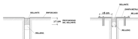
Figura 2.6 Ejemplos de juntas de dilatación
