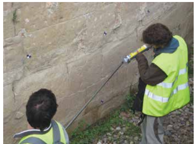
Figura 10.- Colocación de las dianas utilizadas como apoyo fotogramétrico y que van a utilizarse ahora para referir el modelo generado mediante la SFM al sistema de coordenadas del proyecto, así como para analizar la precisión de dicho modelo.
