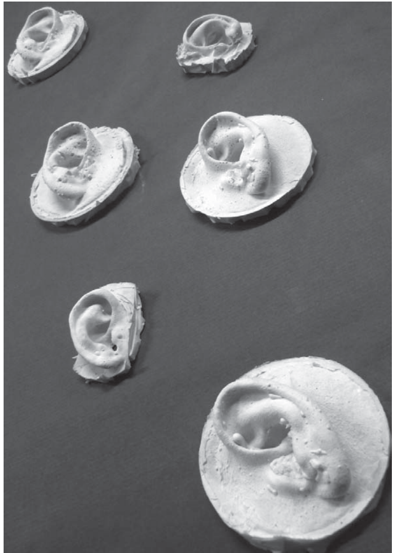
Orejas de alginato para la construcción de cabezas binaurales.
