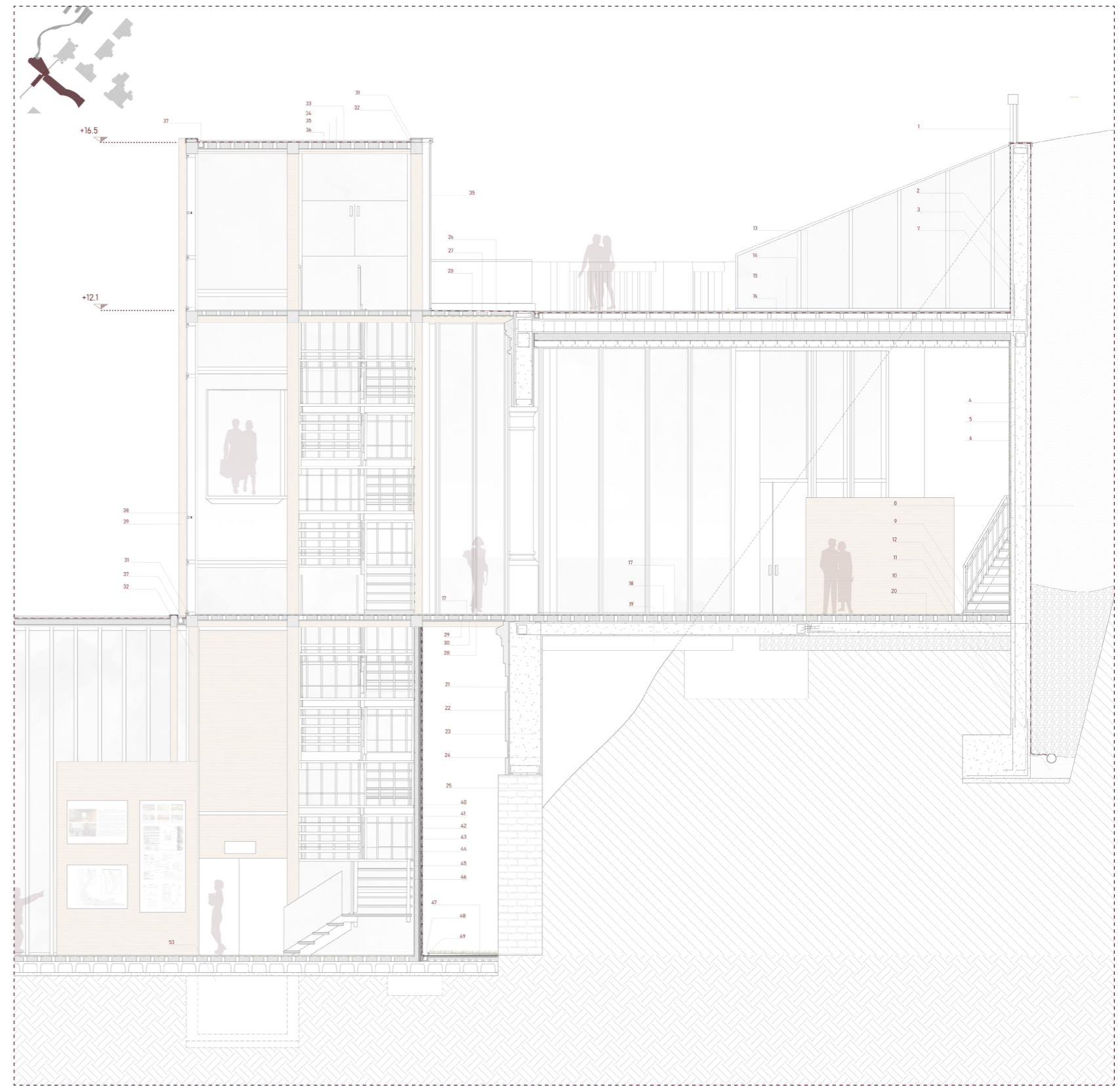
Figura 59: Detalle constructivo de conexión del edificio de entrada y el existente mediante una pasarela.
