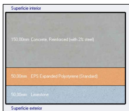
Figura 18 Sección suelo entre sótanos
