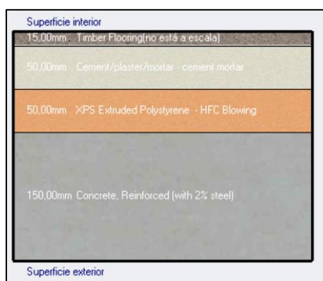
Figura 20 Sección suelo entre plantas
