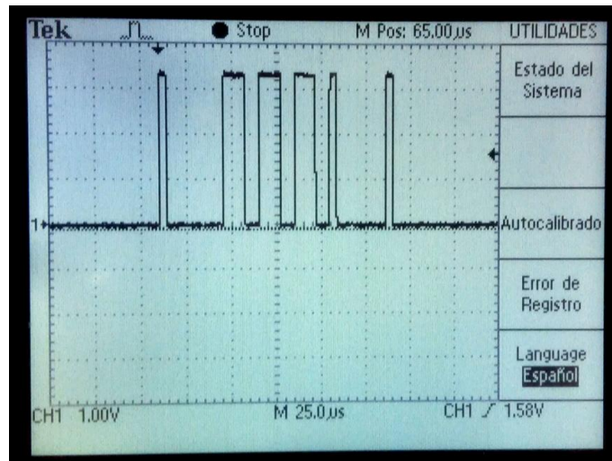
Imagen 4-8 Tren de pulsos en salida de la cámara
