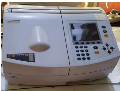
Figura 7: Espectrofotómetro de absorbancia UV-visible utilizado en el laboratorio.
