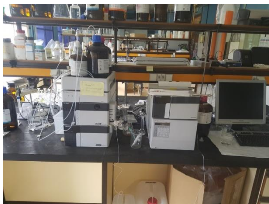
Figura 9: Equipo de HPLC que se usó para el análisis, acoplado al detector de fluorescencia descrito.
