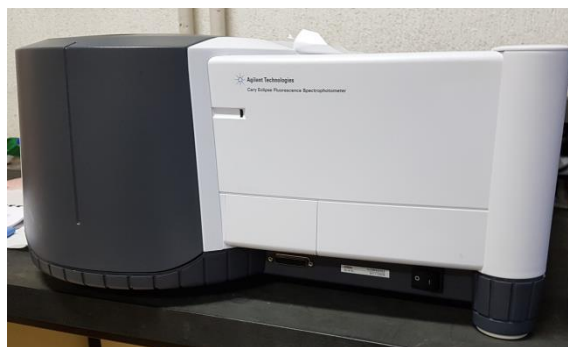
Figura 8: Espectrofotómetro de Fluorescencia empleado en el laboratorio. En los posteriores apartados (diseño del método y cuantificación) se empleó el mismo aparato.
