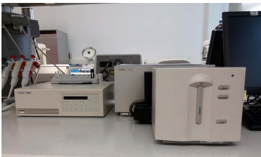
Ilustración 11. Equipo UV/vis Agilent 8453A con celda termostatzada controlada por Peltier T-controler 89090A utilizado en este trabajo.
