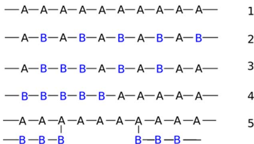
Ilustración 1. Estructuras poliméricas, donde A y B son monómeros diferentes. 1: Homopolímero, 2: Copolímero alternante, 3: Copolímero aleatorio, 4: Copolímero de bloque y 5: Copolímero de injerto.
