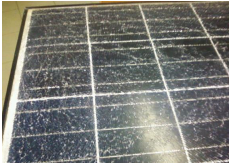
Figura 17. Módulo fotovoltaico con el cristal frontal roto. [13]
