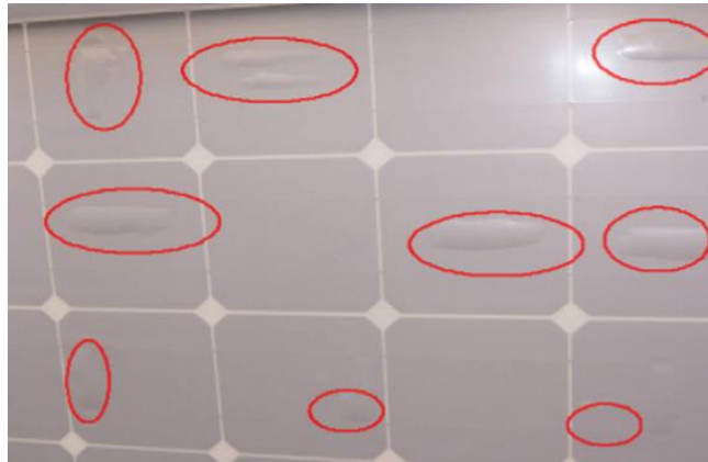
Figura 18. Módulo fotovoltaico con burbujas en la parte posterior. [13]
