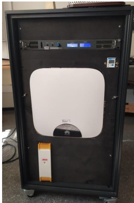
Figura 58. Fuente programable DCP150-8 de la empresa Adaptive Power Systems.
