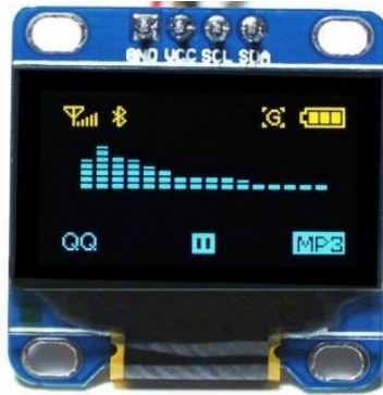
Figura 30. Pantalla OLED utilizada en el proyecto. [23]
