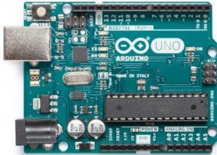
Figura 27. Arduino UNO utilizado en el proyecto. [19]
