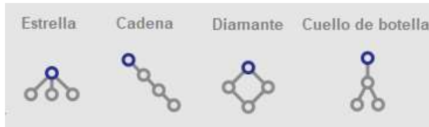
Figura 54. Topologías de red disponibles en la configuración de Renesas Wi-SUN Demonstrator
