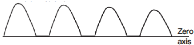
Figura 58: Corriente de magnetización típica [37]
