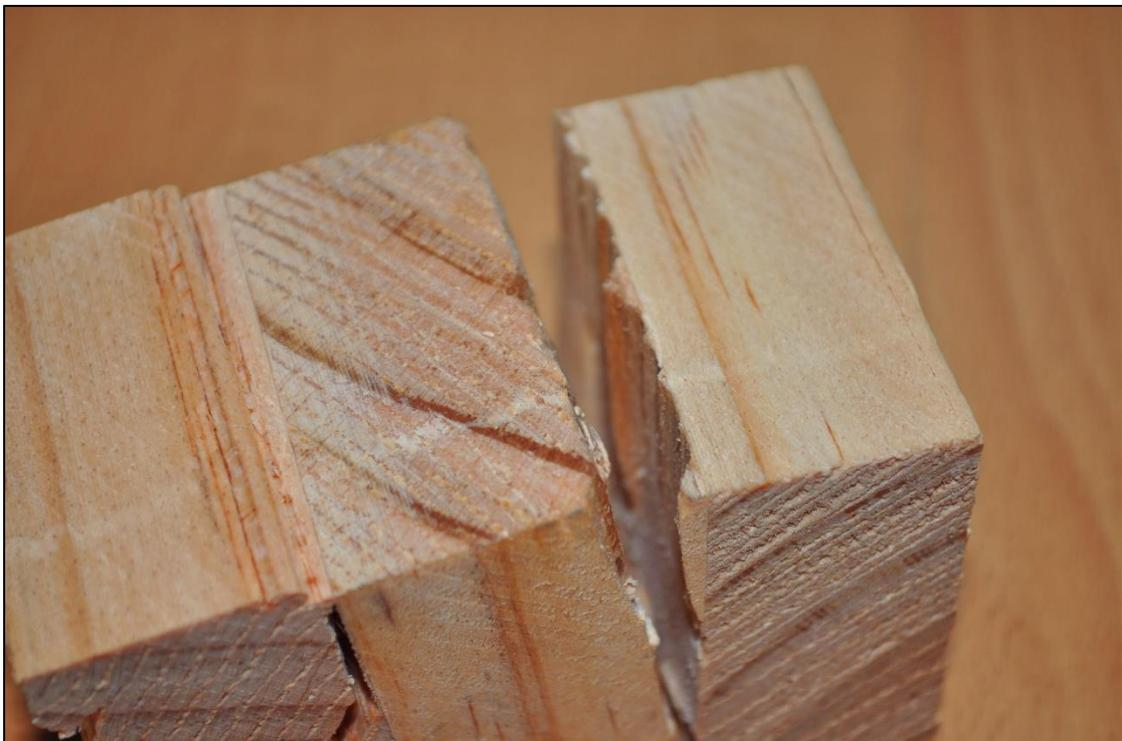
*Fig. 2.13.- Detalle de probeta de CLT delaminada. Se observa la separación entre capas tras un ensayo de delaminación UNE-EN 16351 (imagen, cortesía de Egoín S.A.).*
