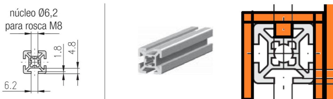
*Fig. 3.3.- Perfil de MungiMatik (20x20mm), vista isométrica del mismo y sección de la guía de la propia carcasa.*
