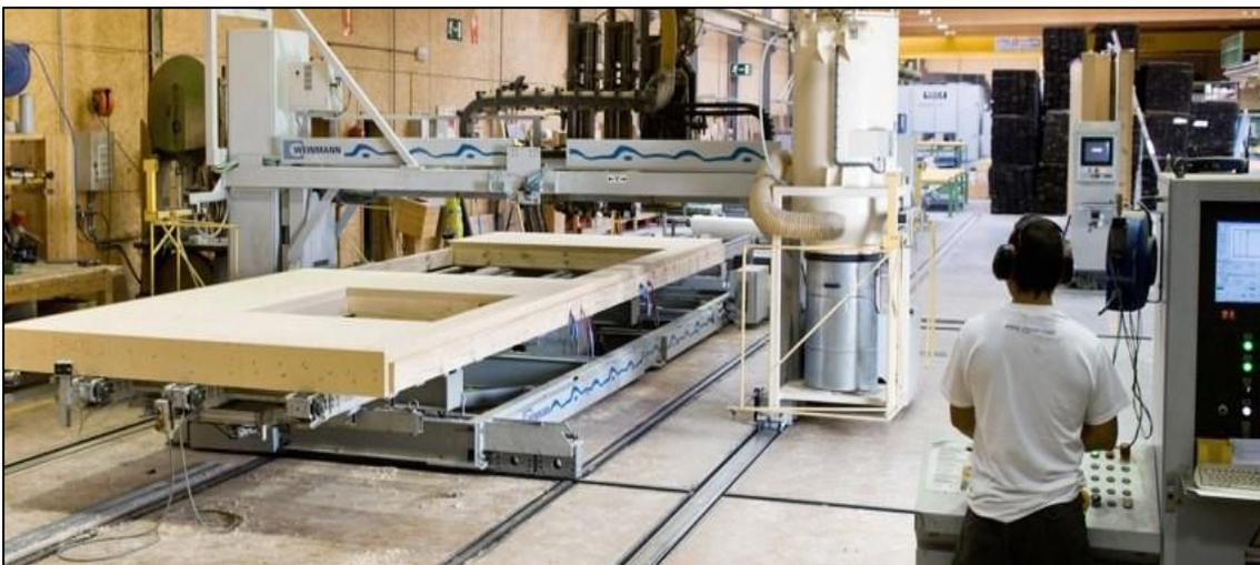
*Fig. 2.2.- Carril de producción de paneles CLT de la empresa Egoin S. A.*
