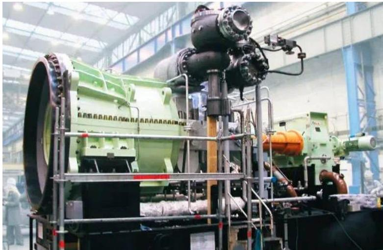
*Ilustración 40. Turbina de vapor SST - 300*
