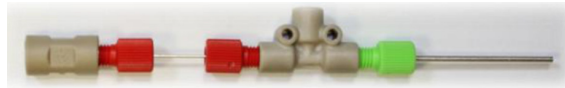
Figura 4.20 Aguja empleada para los ensayos de electrohilado coaxial con un diámetro externo de 1,4 mm y un diámetro interno de 0,6 mm.
