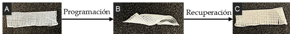
Figura 4.11 Proceso de memoria de forma para una malla obtenida por electrohilado en fundido a partir de una mezcla DGEBA/PCL 50/50.
