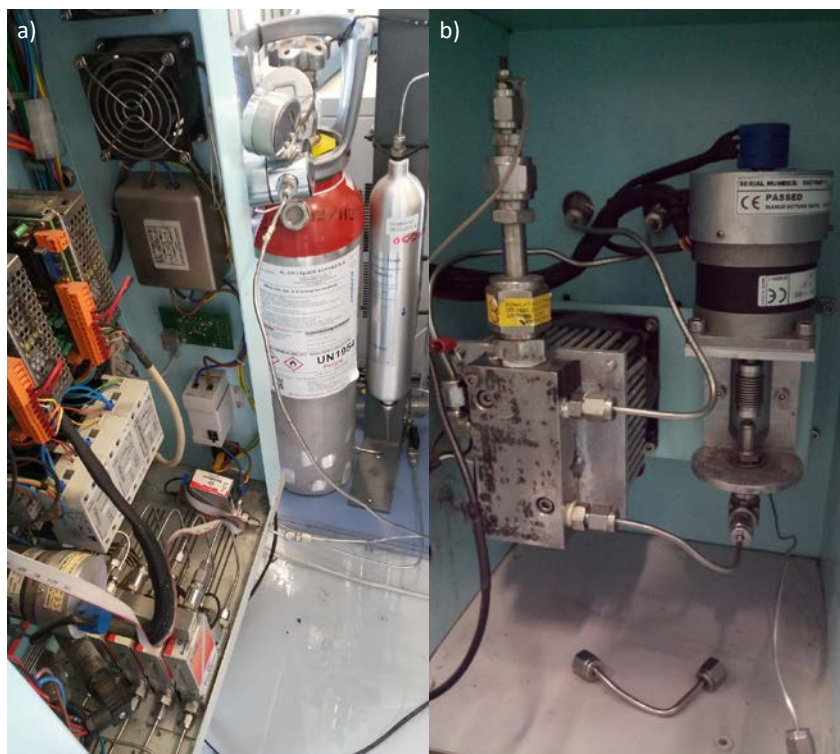
Fig. 3.13. Fotografías a) de los controladores de flujo de entrada de la planta y b) del condensador de salida acoplado a una placa Peltier para la separación de líquido y gas productos de reacción.
