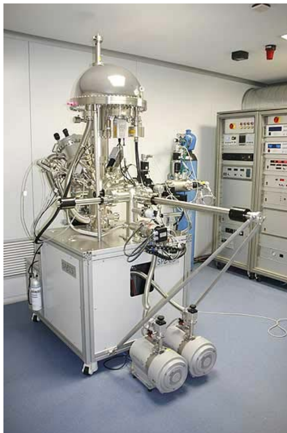
Fig. 3.9. Fotografía del sistema de Espectroscopía Fotoelectrónica de Rayos X (XPS) SPECS.
