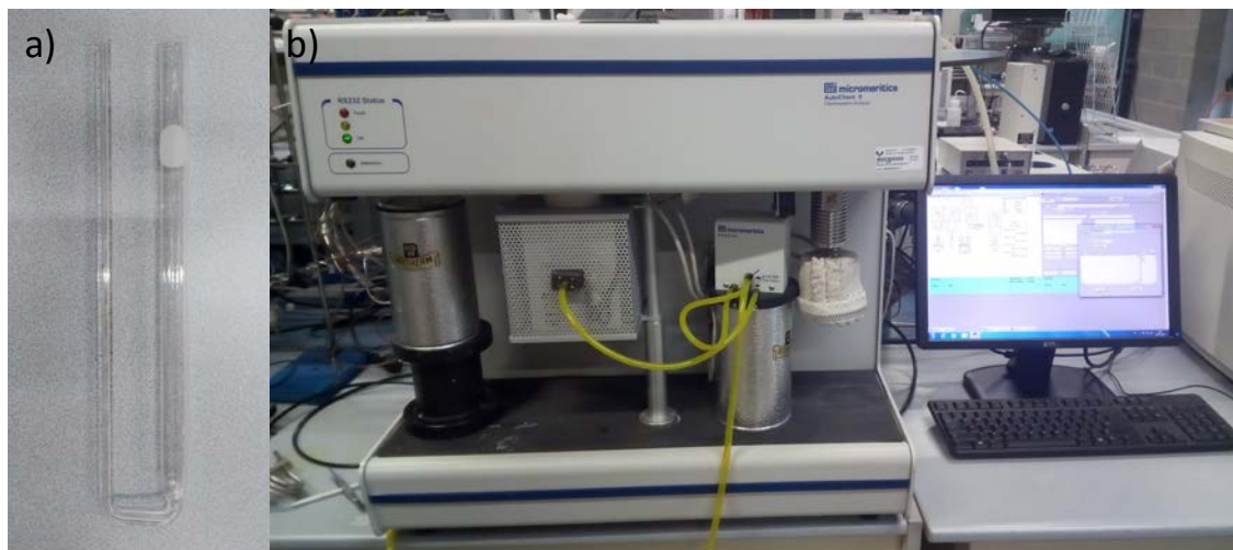
Fig. 3.8. Fotografía de a) celda de análisis del AutoChem y b) equipo de análisis Micromeritics AutoChem II RS232.
