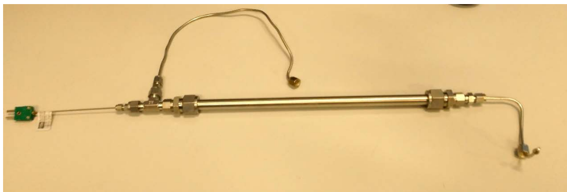
Fig. 3.14. Fotografía del reactor de lecho fijo de 32 cm, \frac{1}{4} " de diámetro exterior, con termopar en el interior del lecho para la lectura de la temperatura en línea.
