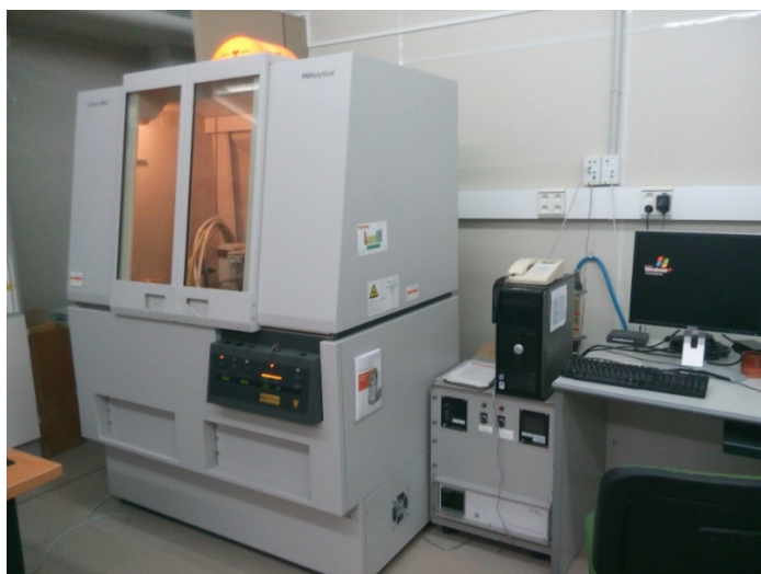
Fig. 3.10. Fotografía del difractómetro de muestra policristalina de geometría theta-theta, Panalytical X'Pert Pro.
