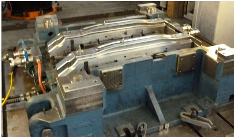
Figura 1. Troquel de estampación en caliente.
