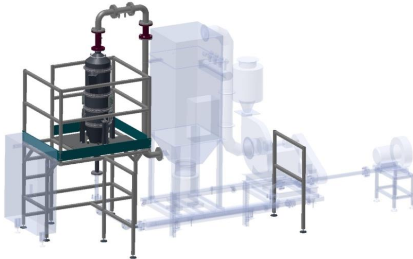
Figura 2.5. Esquema 3D de la planta piloto con el equipo de contacto resaltado. En la imagen se muestra el contacto para secado en batch.
