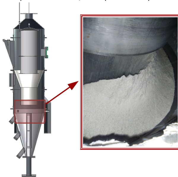
Figura 6.3. Detalle del interior del contactor, donde se aprecia la acumulación de la arena en toda la corona circular entre el confinador de fuente y el encauzador de alimentación ( D_0 = 0.05 m, D_T = 0.054 m, A_0/A_T = 60\% , L_{CF} = 0.5 m de D_{CF} = 0.2 m, con encauzador interno)
