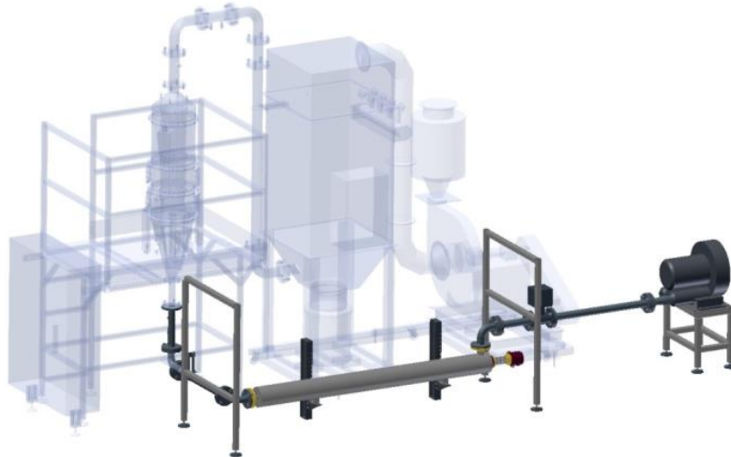
Figura 2.4. Esquema 3D de la planta piloto con el conjunto de aporte de aire y calor resaltado.
