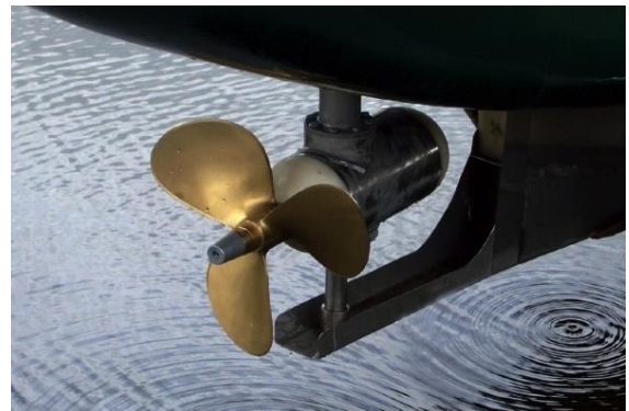
Fig. 9 Propulsor pod montado en la mecha del timón.
