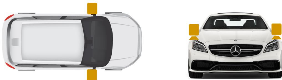
Ilustración 25: Distribución de cámaras: Solución final adoptada
