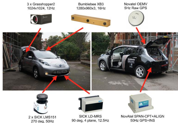
Ilustración 8: Disposición de los sensores en RobotCar
