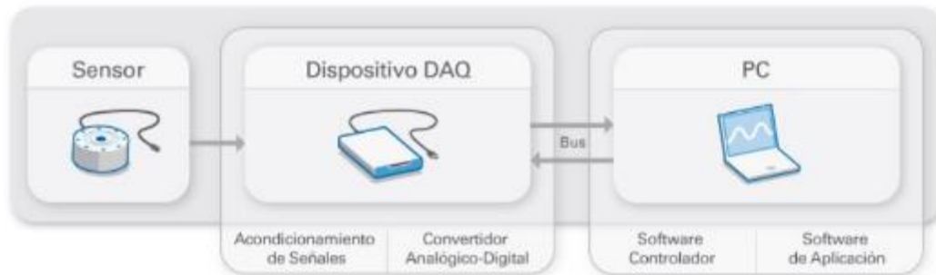
Figura 1.3.- Unidades necesarias para registrar datos a partir de un sensor[7].
