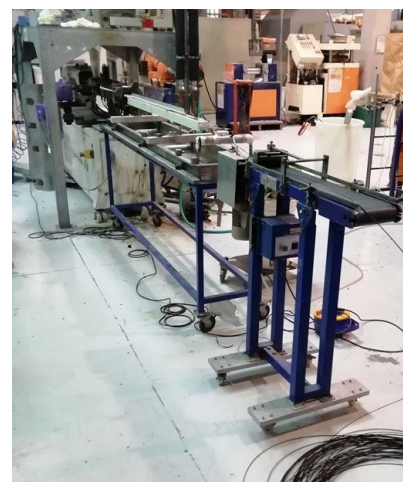
Figura 5.1.- Extrusora de doble husillo corotante Leistritz (Gaiker).
