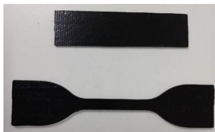
Figura 5.35.- Probetas rectangulares de PC y probetas halteras troqueladas de SEBS/SBS.
