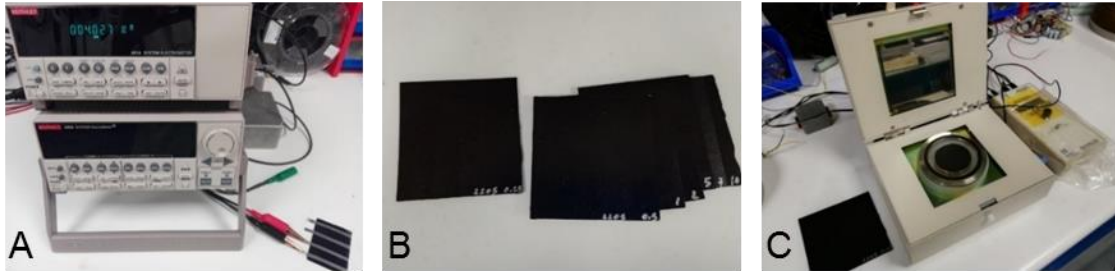
Figura 5.14.- A) Medidas de dos puntas, B) Placas obtenidas por laminación y equipos de medidas eléctricas, C) Sistema de anillos concéntricos y Megaohmímetro.
