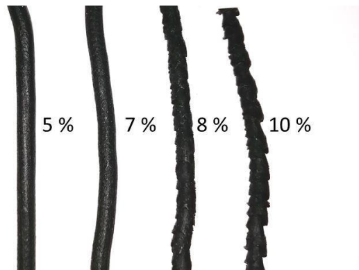
Figura 6.6.- Aspecto de los filamentos para FDM de SBS/SEBS con MWCNT.
