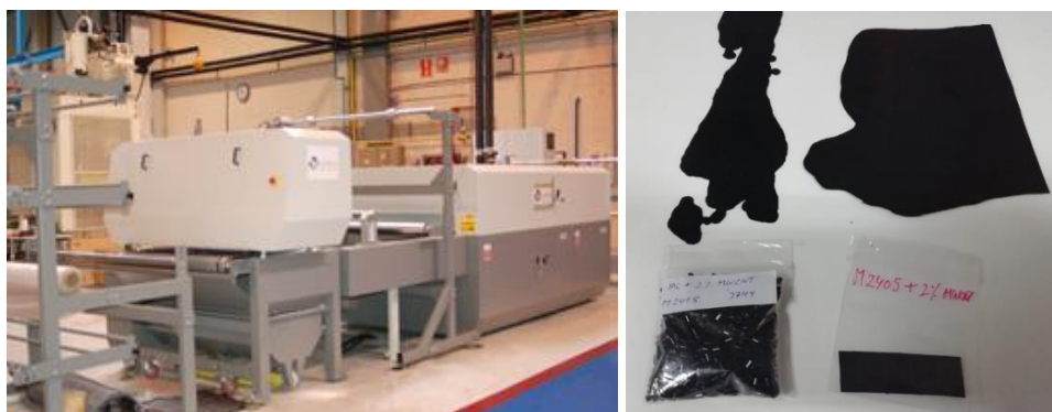
Figura 5.2.- Equipo de laminación RELIANT (Gaiker) y muestras laminadas.
