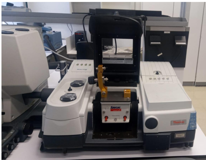
Figura 15: Espectrómetro Nicolet 6700 equipado con el Golden Gate, ATR.
