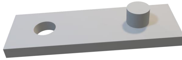
Figura 67: Diseño tridimensional de geometría compleja utilizado para valorar la calidad de las piezas impresas.
