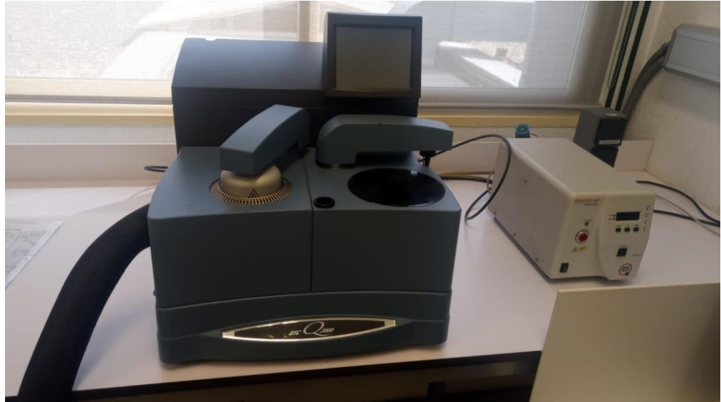
Figura 16: Calorímetro Q2000 (izq.) y accesorio fotocolorimétrico Omnicure S2000 (dcha.).
