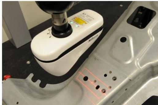
Figura 5.2. Integración de un escáner láser en una CMM [19].
