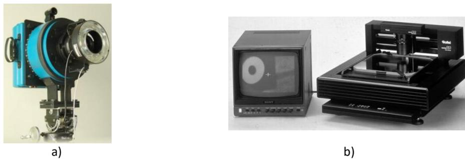
Figura 2.2. a) Cámara de gran formato GSI CRC-1 (1986), b) Comparador digital de imagen Rollei RS-1 (1988) [3].
