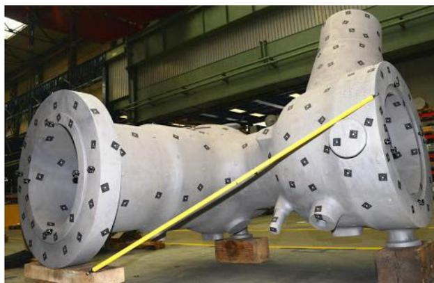
Figura 5.20. Colocación de objetivos en una carcasa de válvula [53].
