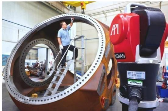
Figura 5.4. Medición con objetivo retrorreflectante [26].
