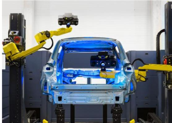
Figura 5.19. Integración de la fotogrametría en una cadena de montaje [52].
