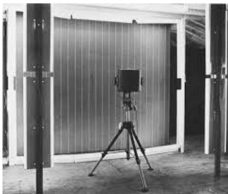
Figura 5.50. Patrón de calibración basado en líneas [66].
