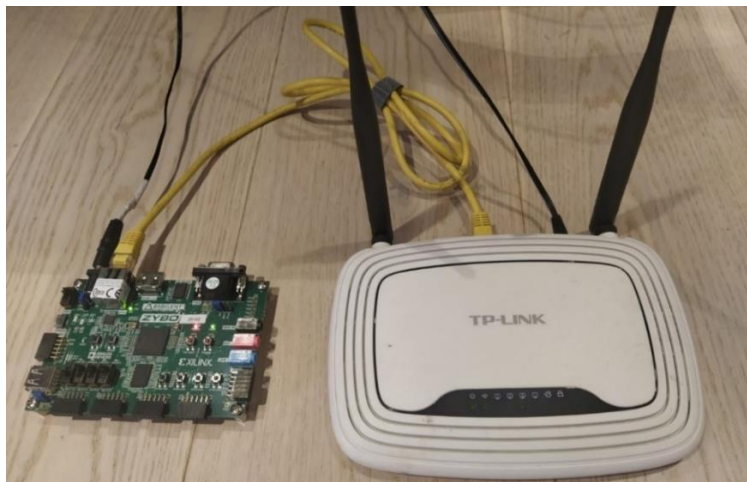
Figura 72: Conexión ethernet entre placa Zybo y Rúter
