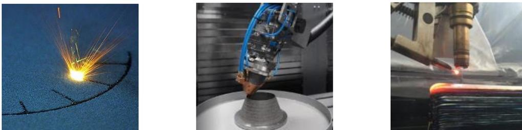
Figura II-25. Procesos de fabricación aditiva. Izq, SLM. Centro, LMD. Dcha, WAAM.
