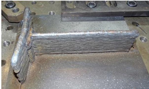
Figura III-23. Demostrador en T en acero con estrategia rampa en inicio y finales.
