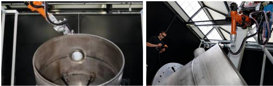
Figura II-22. Célula de fabricación flexible de Fabricación Aditiva [AMRC, 2021]
