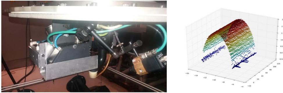
Figura III-7. Escaner laser instalado en máquina y perfil tipo que se obtiene de un cordón depositado
