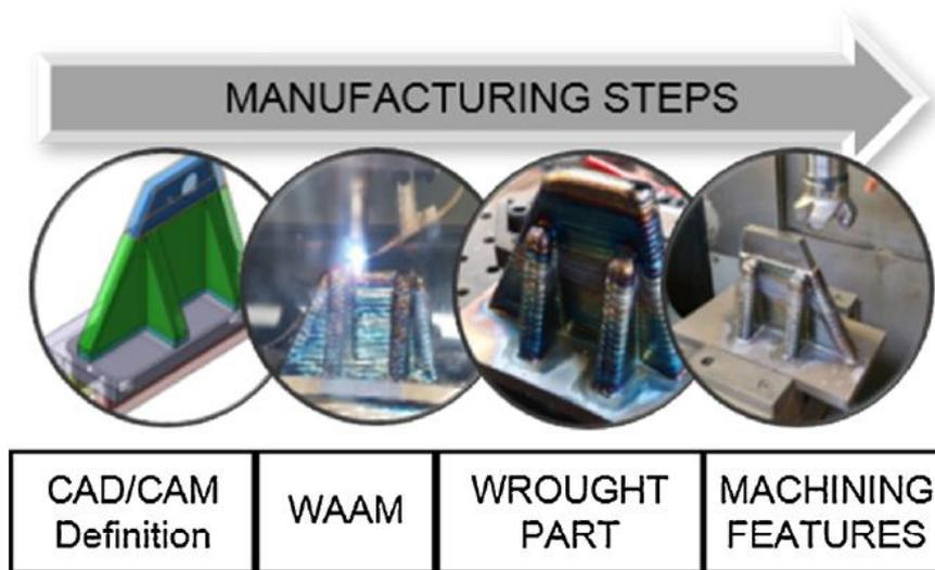
Figura VI-2. Secuencia de fabricación del demostrador mediante PAW
