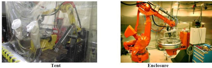
Figura II-14. Sistemas de cerramiento para materiales, como el Titanio, que necesitan trabajar en una atmósfera de Argón [Cranfield, 2021].
