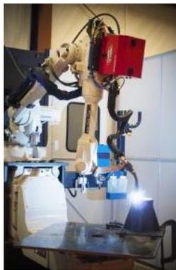
Figura II-23. Sistema de AM robótico multi-material [Wolf Robotics, 2021]
