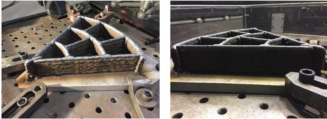
*Figura III-26. Pieza fabricada en acero para validar el control de altura.*
