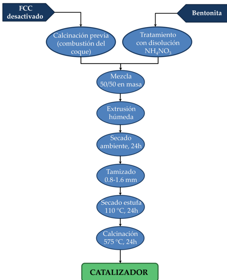
Figura 2.1. Esquema del método de preparación del catalizador FCC desactivado.
