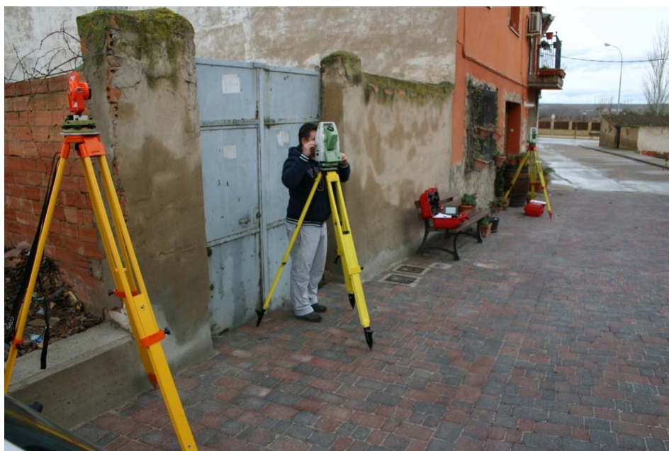
Figura 9. Observación en campo, en la imagen se aprecia la utilización de dos estaciones totales así como el uso de trípodes con prismas para materializar los puntos de estacionamiento.
