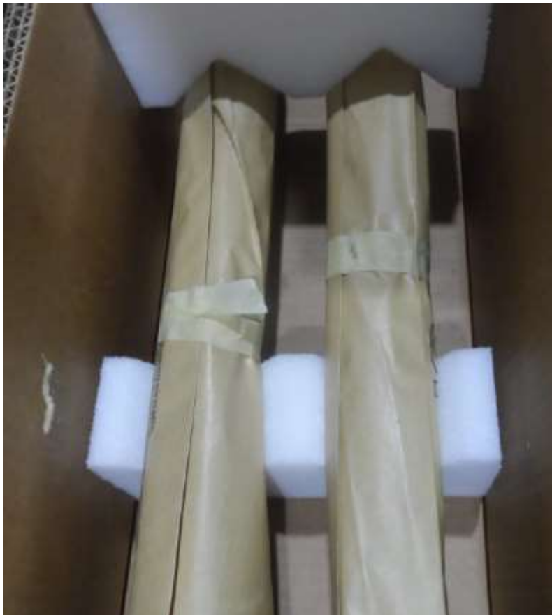
Figura 7.7: Colocación del husillo dentro de la caja
