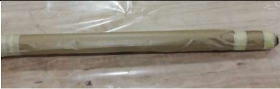
Figura 7.2: Cerramiento con cinta del embalado del husillo
