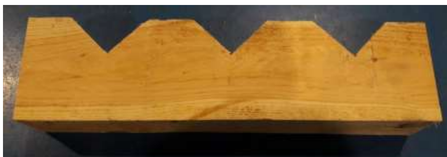
Figura 7.5: Calzo en V de madera
