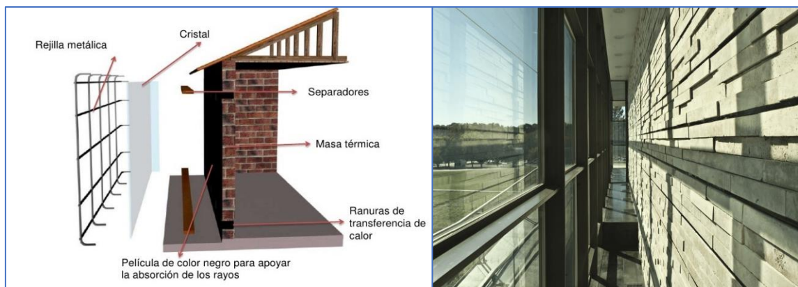
Figura 1 Esquema y fotografía del muro Trombe
