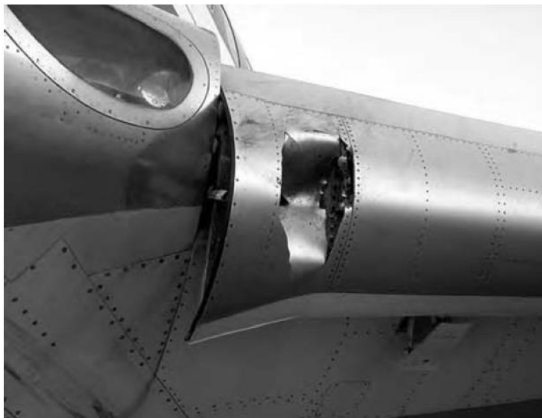
Figura 2. Fractura de la chapa del ala de un jet de pasajeros, [11].
