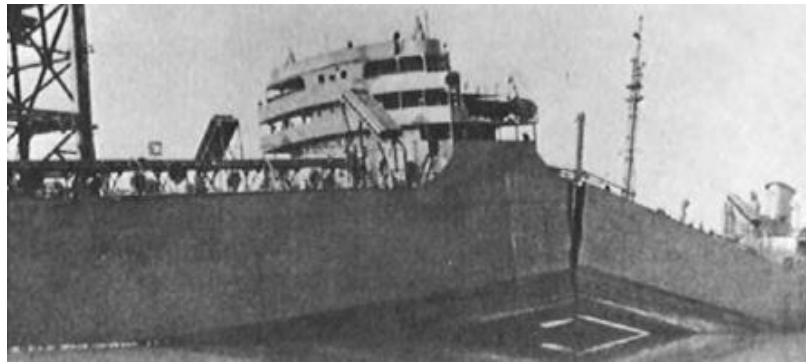
Figura 1. Rotura del petrolero Schenectady, [11].
