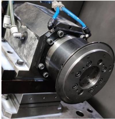
Figura 50. Disco diamantador Winter
