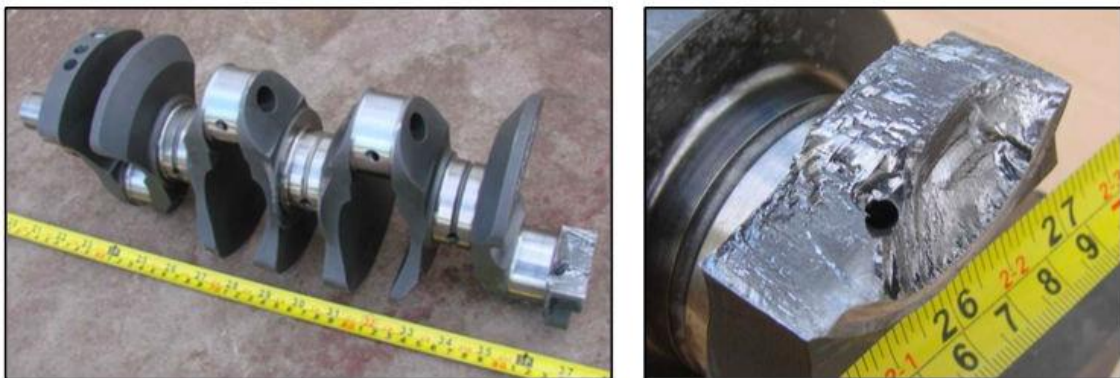
Figura 1.3. Fallo a fatiga del cigüeñal por estar sometido a elevados esfuerzos de torsión [6].
