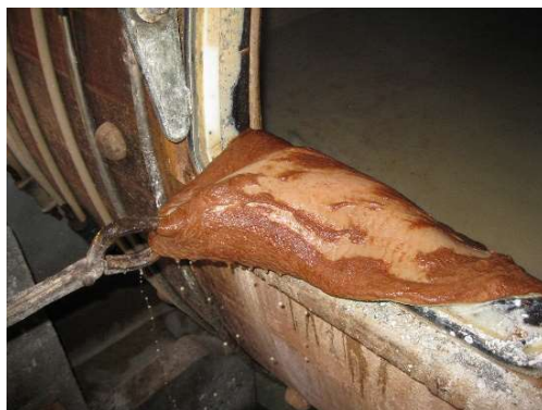
Photo 7. Extraction des peaux du foulon après bain d'épilage
