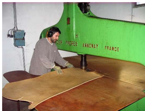
Photo 15. Battage d'un coupon pour écraser la fibre
