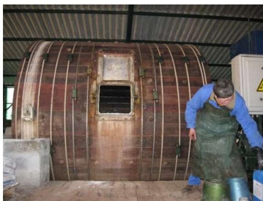
Photo 6. Foulon de tannage à la tannerie Garat
