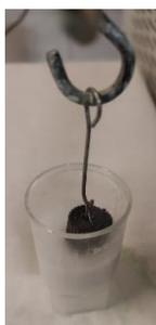
Imagen 6. Montaje para el proceso de recubrimiento por inmersión.
