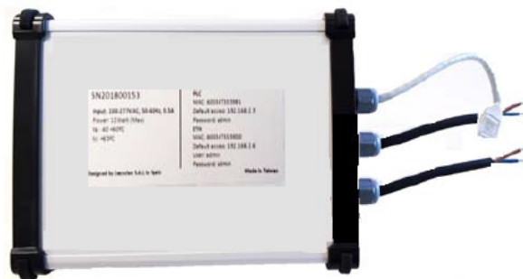
Fig.1.1. Cabecera PLC de banda ancha.
