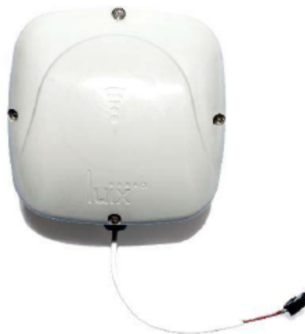
Fig.1.3. Sensor de microondas para detección de vehículos y personas a larga distancia.
