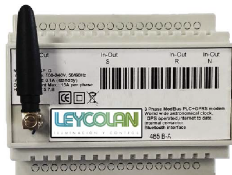
Fig.1.4. Cabecera PLC de banda estrecha.
