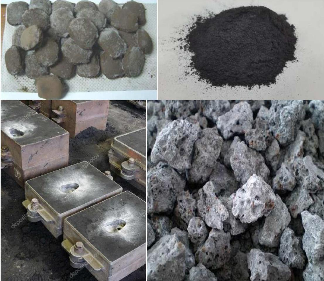
Imagen 17: Los cuatro tipos de residuos que genera el proceso de producción del acero (polvos de acería, cascarillas de laminación, arenas de fundición y escorias de acería).
