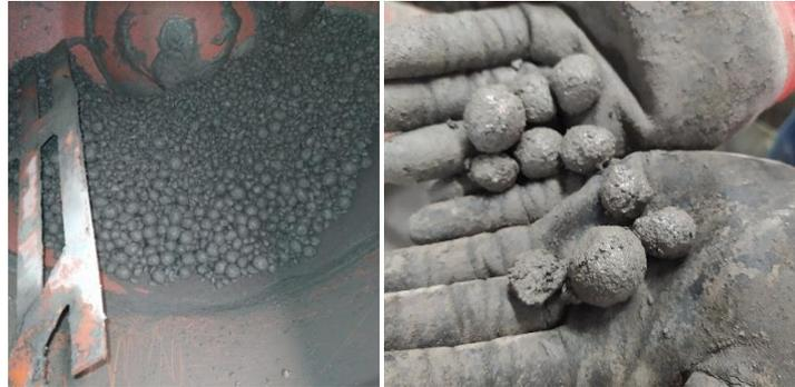
Imagen 44: Las bolas generadas durante el proceso de amasado con RCD.
