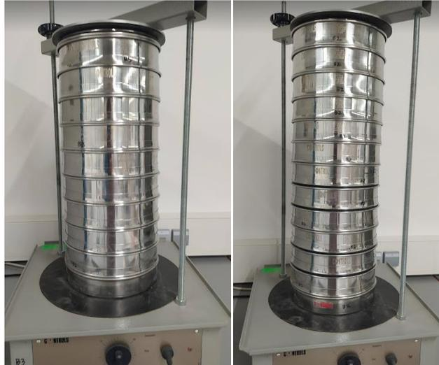
Imagen 34: Las columnas de tamices empleadas en el ensayo.
