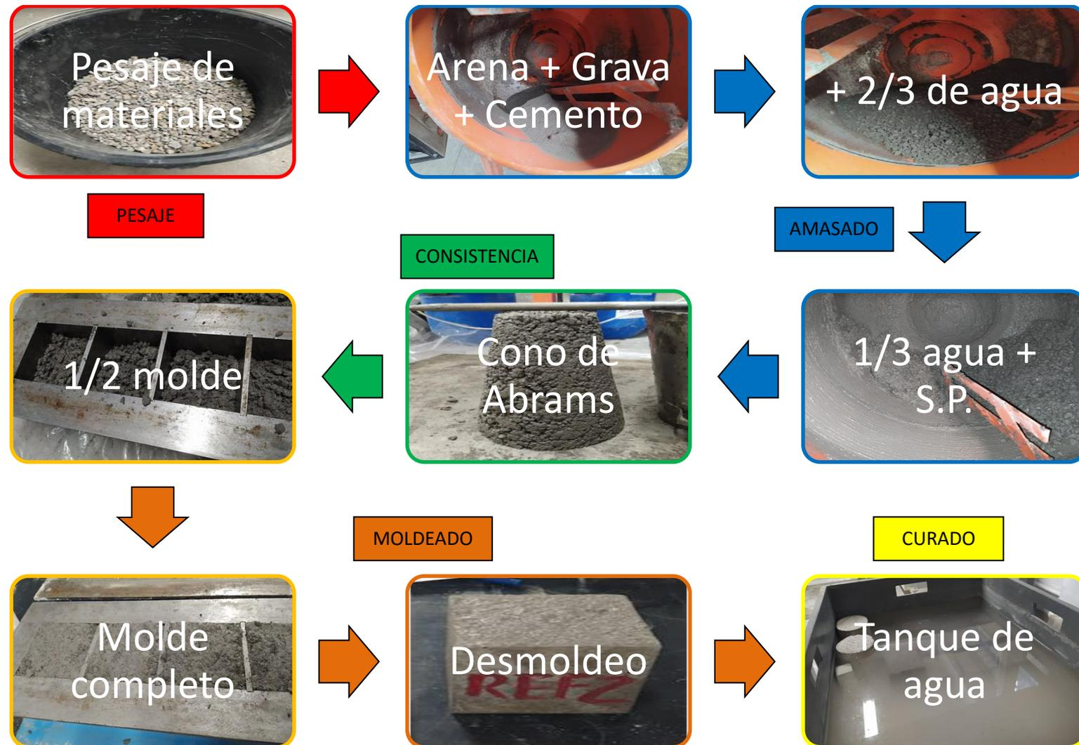
Imagen 43: Esquema del proceso de las amasadas.
