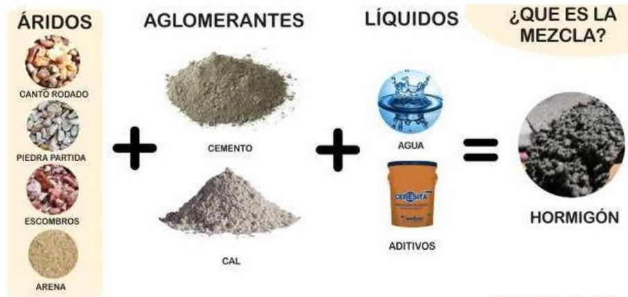
Imagen 8: Esquema de la composición del hormigón.
