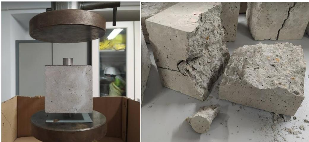
Imagen 49: Ensayo de doble punzonamiento.
