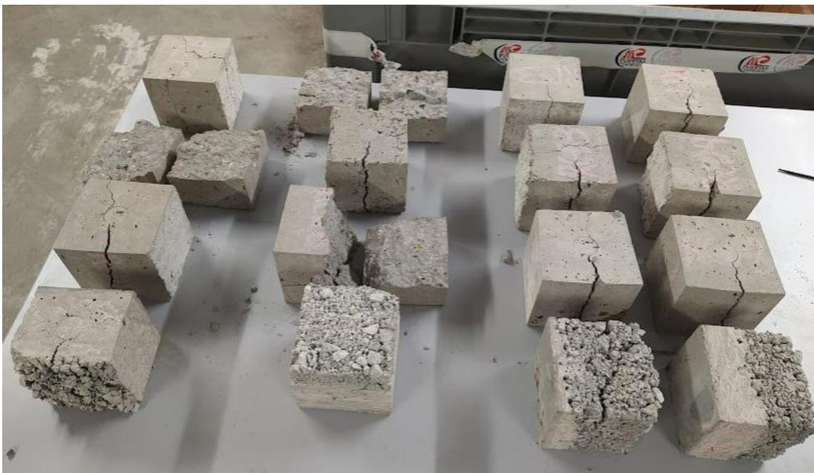
Imagen 53: Probetas tras realizar el ensayo de doble punzonamiento.
