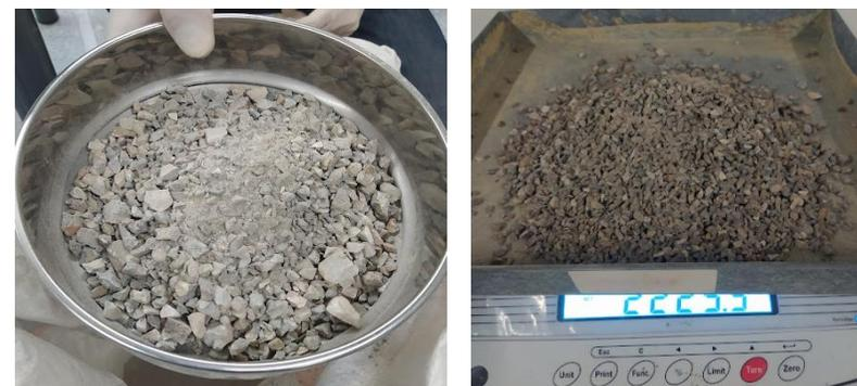
Imagen 37: Análisis granulométrico de los residuos de construcción y demolición.
