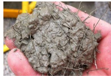
Imagen 12: Hormigón con fibras de acero.
