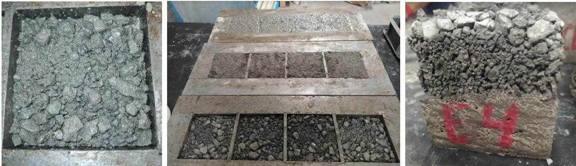
Imagen 45: Probetas moldeadas y desmoldadas (referencia a la probeta N°4 de escoria).
