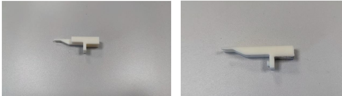
Ilustración 59 Dispositivo desconexión (una uña) (izq.) y nuevo dispositivo de desconexión (dos uñas) (dcha.)
