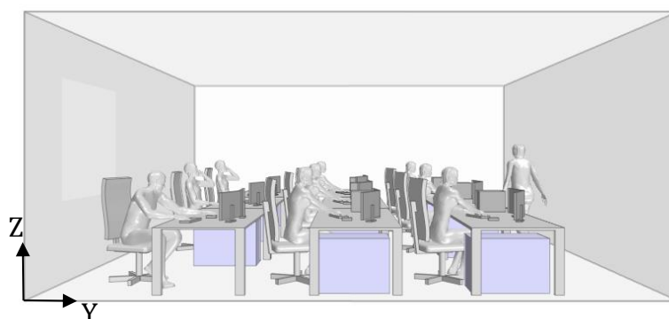
Figura 4. Geometría del dominio computacional. Medidas; X = 8.5 metros, Y = 7 metros y Z = 3.1 metros. El aula se mantiene a una temperatura de 21 °C y una humedad relativa del 42 % a presión atmosférica constante. Fuente: Elaboración propia.
