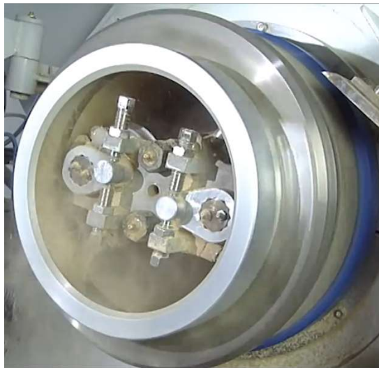
Irudia 62: Egurrezko pelletak egiteko makina.
