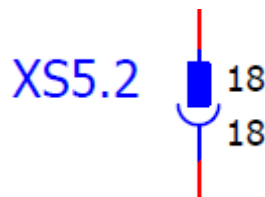
Figura 20. Representación de los pines de los conectores.
