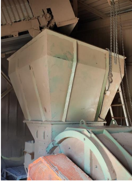
Imagen 3.3. Molino de arcilla
