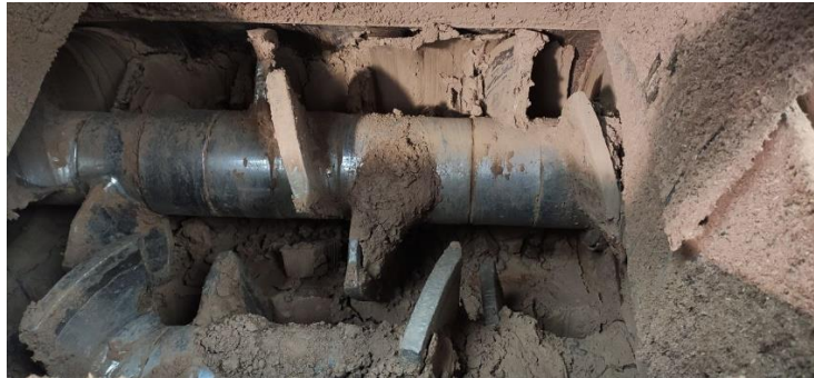
Imagen 3.16. Amasadora interna de la extrusora
