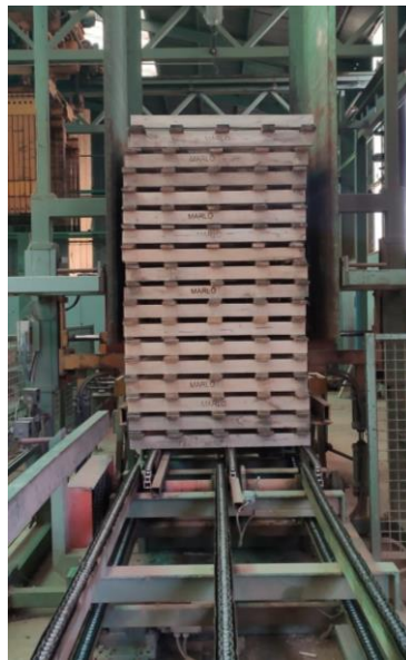
Imagen 3.22. Dispensador de pallets.
