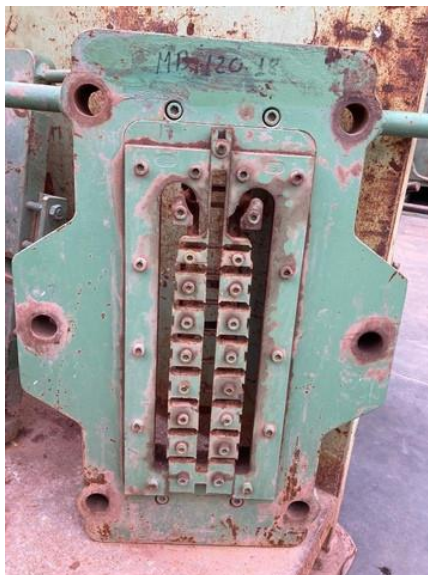
Imagen 3.17. Molde del ladrillo
