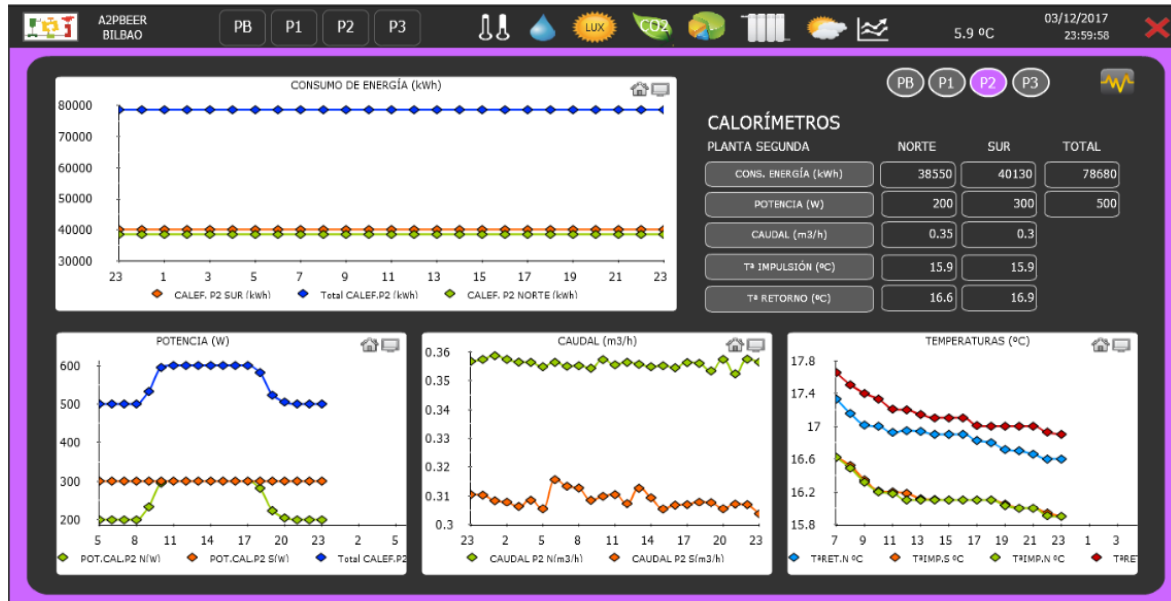
Figura 3.1. Monitorización del proyecto A2PBEER sobre el edificio bajo estudio.
