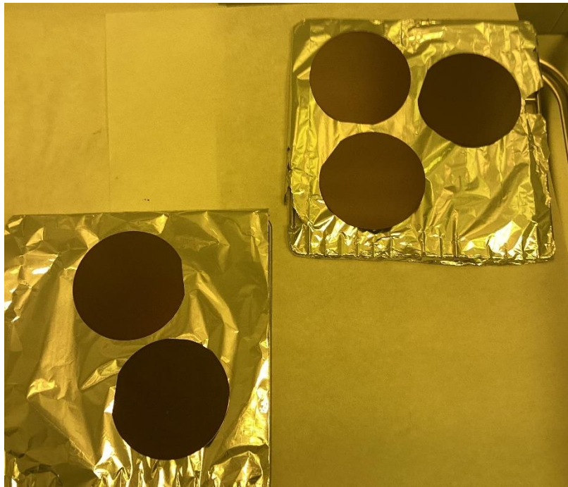
Figura 26. Obleas en bandejas con resina recién depositada
