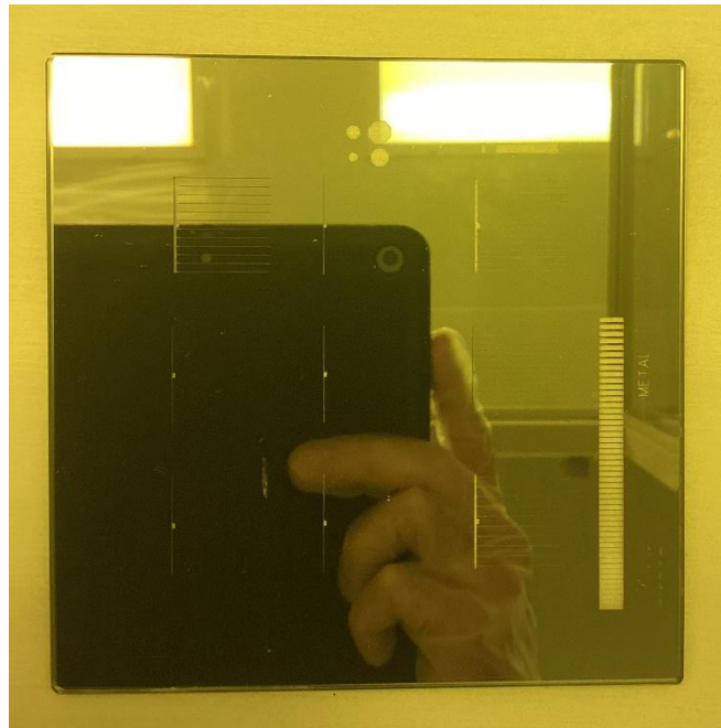
Figura 28. Máscara empleada para la litografía
