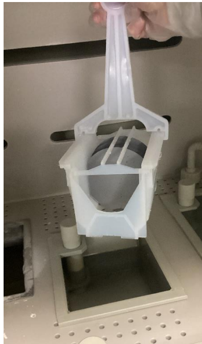
Figura 21. Baño en ácido fluorhídrico
