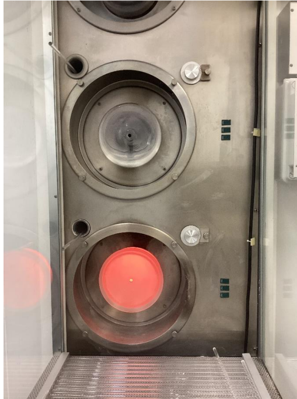
Figura 24. Horno de cuarzo del laboratorio para la difusión del fósforo
