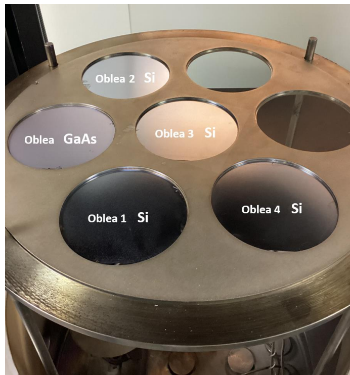
Figura 33. Disposición de las obleas en el planetario de la campana evaporadora
