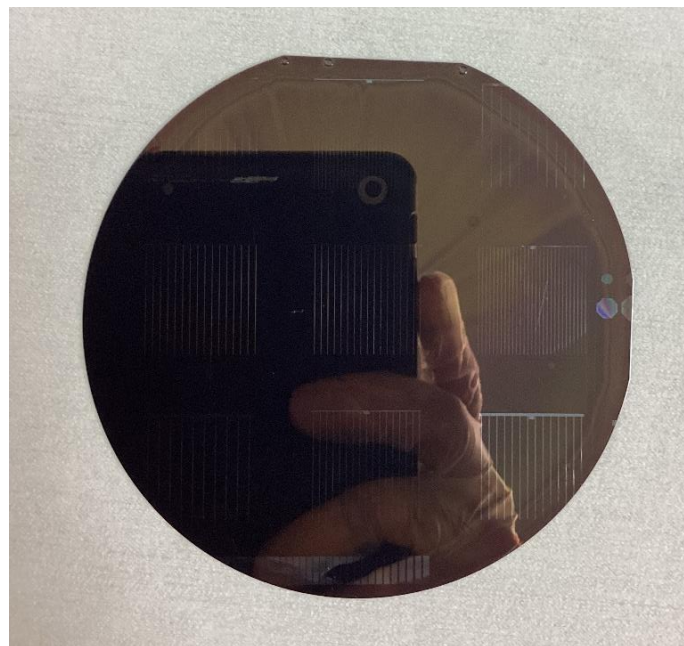
Figura 31. Oblea de GaAs después de la litografía
