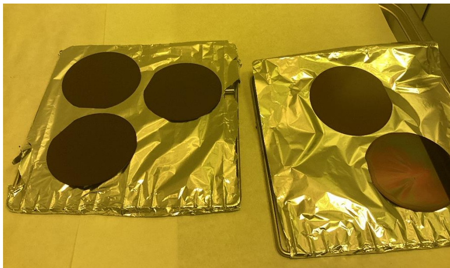
Figura 27. Obleas en bandejas con resina seca (Después del horno)
