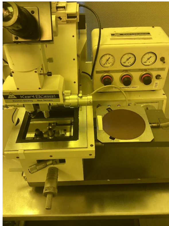
Figura 29. Oblea con resina antes en máquina de litografía
