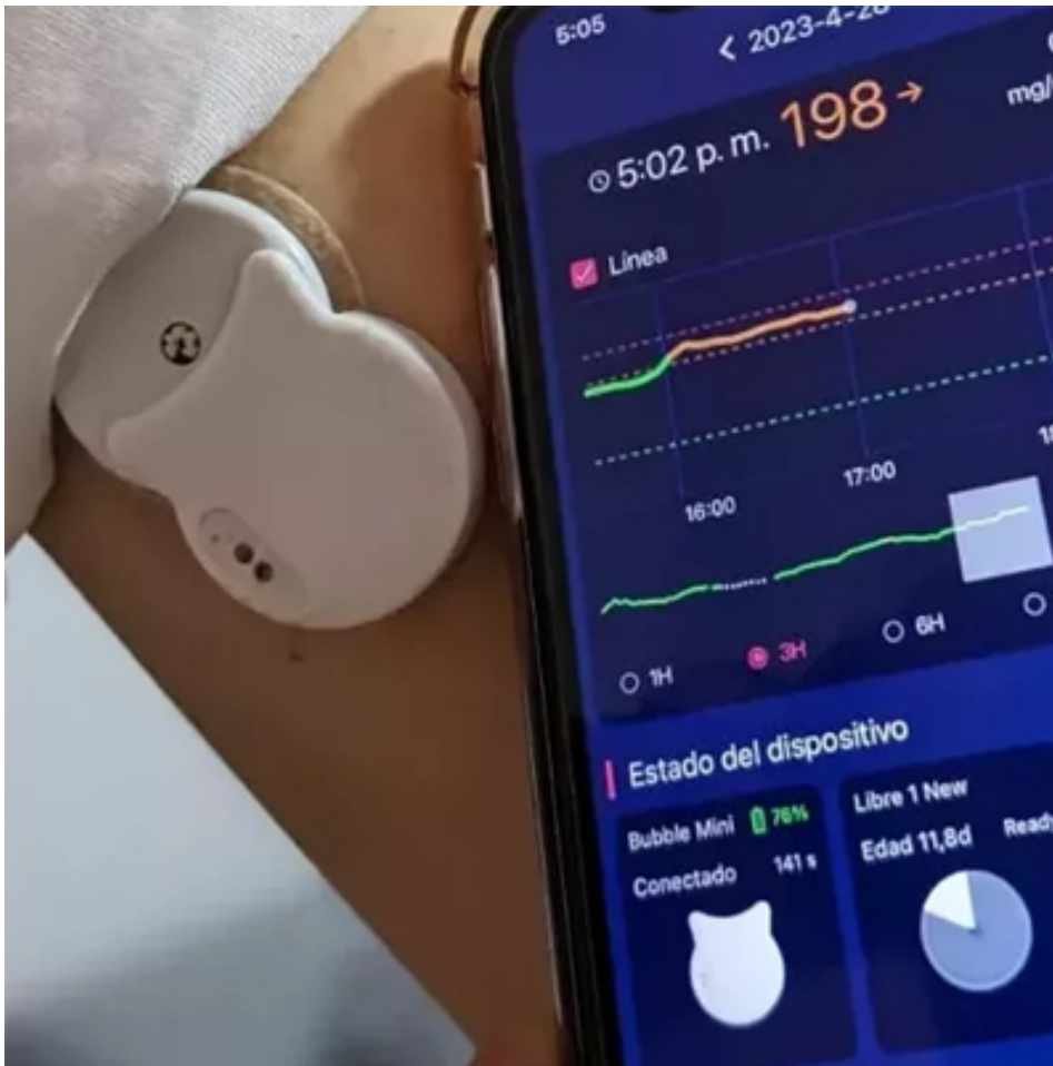
Irudia 3.3: Abbott FreeStyle Libre CGM-a, Bubblan Bubble Mini irakurlea eta Dia-box aplikazioaren interfaze nagusia.
