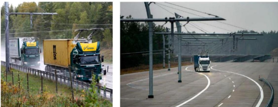
Fig. 2. Sistema de recarga mediante catenaria. [2] y [3] respectivamente.
