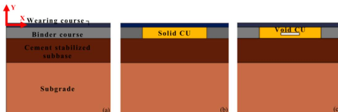
Fig. 40. Sección transversal de la tRoad (a), eRoad con bloque compacto (b) y eRoad con bloque hueco (c). [10]
